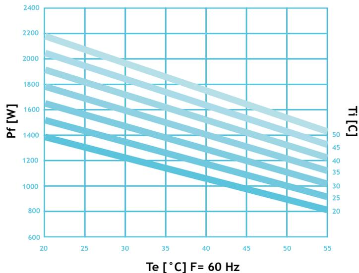
$T_i$  [°C] F = Température souhaitée à l'intérieur de la cabine
